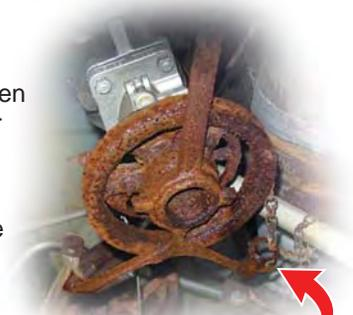
**KORRODIERTES GUSSEISEN-KETTENRAD** zeigt die Vorteile von Edelstahl
