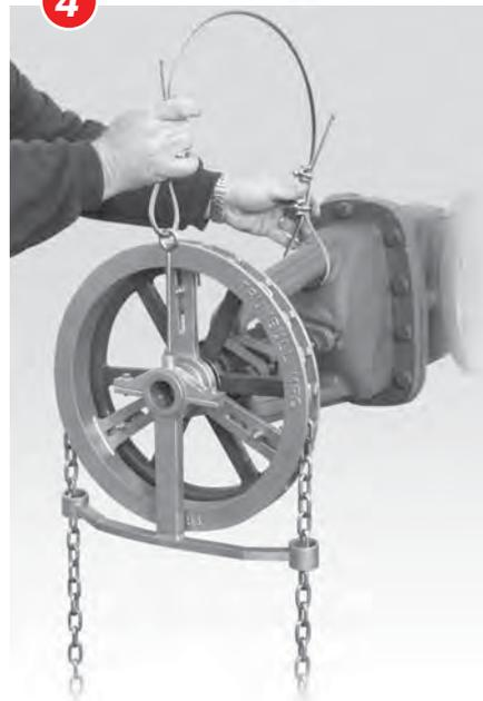
Das andere Ende des Kabels um einen Sicherungspunkt schlingen.
