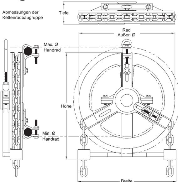
Hinweis: Kettenräder werden üblicherweise mit dem Befestigungs-Set „B“ geliefert. Passende Handraddurchmesser finden Sie auf Seite 4. In der Tabelle rechts finden Sie zusätzliche Passgrößen für die Befestigungs-Sets „A“ und „C“.
