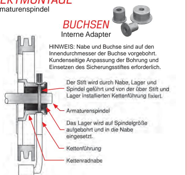
**HINWEIS:** Nabe und Buchse sind auf den Innendurchmesser der Buchse vorgebohrt. Kundenseitige Anpassung der Bohrung und Einsetzen des Sicherungsstiftes erforderlich.
