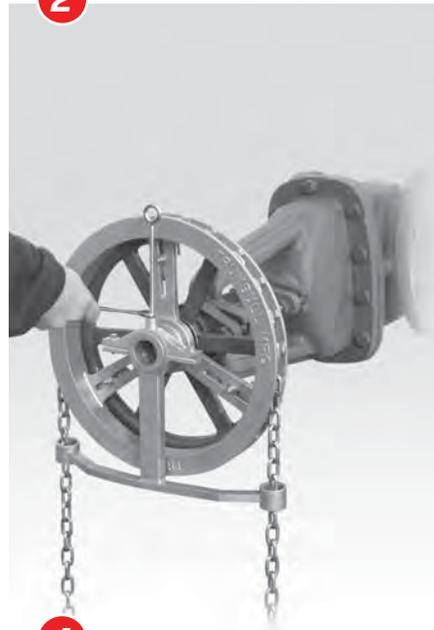
Die Ringschraube des Rückhaltesystems installieren und mit einer Kontermutter sichern.
