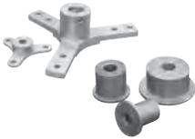
Zur Direktmontage an der Armaturenspindel sind **ZWEI ADAPTER** erhältlich. Mit beiden Adaptern wird das Kettenrad wie auf Seite 3 dargestellt auf die Spindel montiert. Für TRS-4 sind zur Montage des Sternadapters Gewindebohrungen am Kettenrad und besondere Schrauben nötig. Halterungen zum Befestigen des Sternadapters an den Kettenrädern TRS-6 bis TRS-29 sind im mitgelieferten Befestigungs-Set enthalten.
