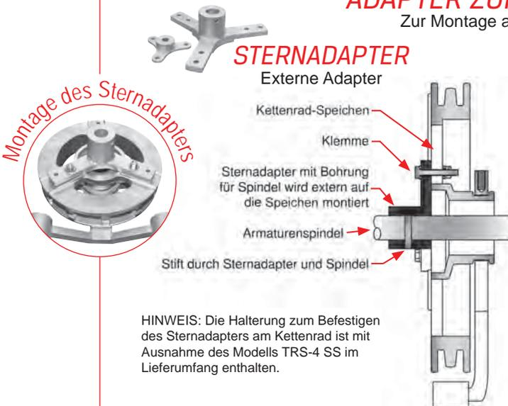
**HINWEIS:** Die Halterung zum Befestigen des Sternadapters am Kettenrad ist mit Ausnahme des Modells TRS-4 SS im Lieferumfang enthalten.
