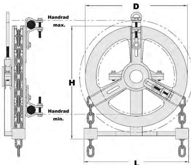
Trumbull Kettenräder ermöglichen das Betätigen von Armaturen in schwer erreichbaren Einbauhöhen. Die Kettenräder sind geeignet zur direkten Montage auf ein vorhandenes Handrad.
