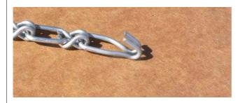
3. Kettenende zur geschlossenen Seite des Kettenschlosses gleiten lassen.
