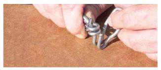
2. Kettenschloss in die Schlaufe des letzten Kettengliedes am Kettenende wie abgebildet einfädeln.
