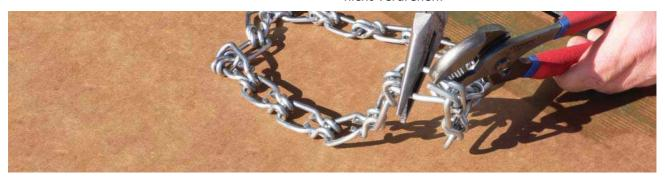
Das offene Ende des Kettenschlosses mittels Zange über dem Kettenende einbiegen, sodass sich das Kettenende nicht aus der gebogenen Schlaufe lösen kann.
